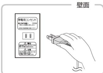
接続する機器の合計消費電力は1500VA以下（AC 100V で最大15A 以下）になるようにしてください。
