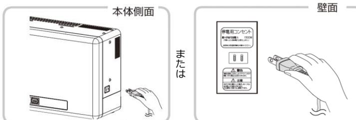
接続する機器の合計消費電力は1500VA以下（AC 100Vで最大15A以下）になるようにしてください。
